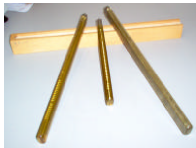
Brocche di tipo lungo o corto per l'esecuzione di intagli a U/V su provini da utilizzare con il pendolo
