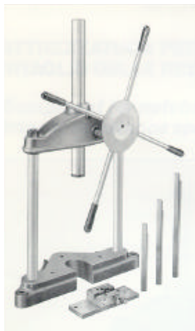
Brocciatrice ed attrezzo di brocciatura per l'esecuzione di intagli su provini da utilizzare con il pendolo
